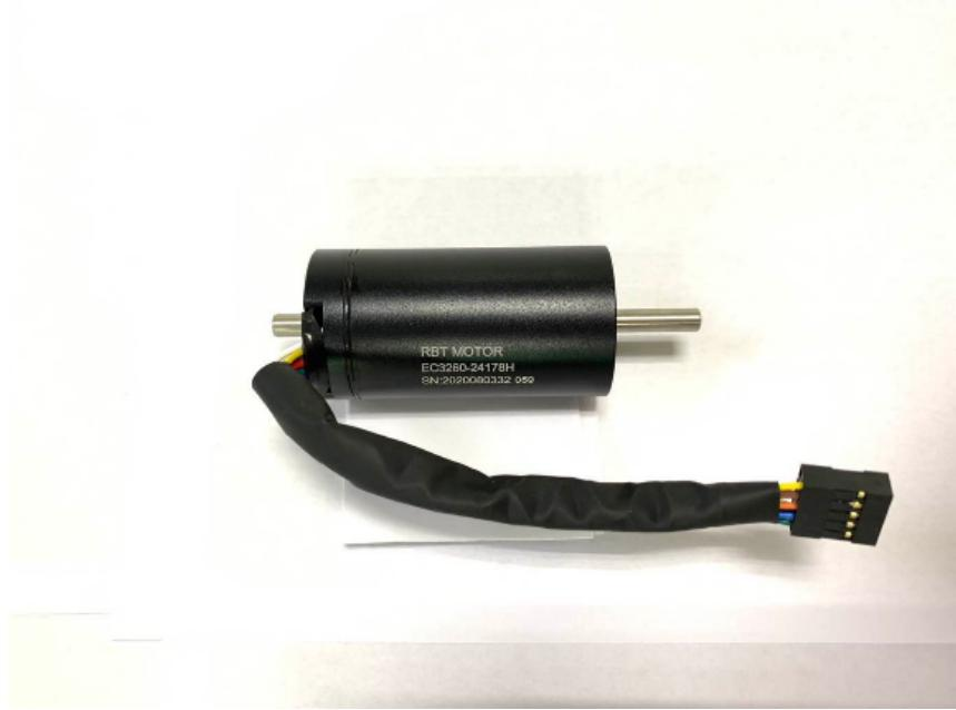
空心杯无刷电机的力矩计算方法：刷电机现在的型号是多种多样，看上去不同型号之间的空心杯无刷电机差不多。空心杯无刷电机分电子换向与内置霍尔传感器换向两类。前者集成驱动电路，可简单控制转速等，后者需外加驱动器构成伺服系统，因此称之为无刷伺服电机。因此如果在实际的应用场景中的话，我们就会知道不同型号的力矩都有一定的差距，而很多行业对空心杯无刷电机的力矩也不一样，因此我们要学会计算空心杯无刷电机的力矩。下面就为大家简单介绍一下怎样计算电机的力矩？即力矩 $T = 功率 P * 9.8 / 转数 N$ 或者互相转换因素也可以成为 $T * 转数 / 9.8 = 功率$ 。为了更好的满足市场需求，通常采用定制直流空心杯无刷电机产品技术服务。武汉振动刀精密空心杯无刷电机
