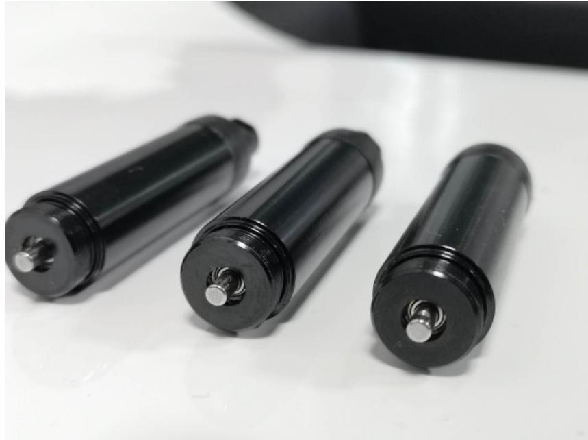
由于直流空心杯无刷电机是以自控式运行的，所以不会像变频调速下重载启动的同步电机那样在转子上另加启动绕组，也不会在负载突变时产生振荡和失步。中小容量的无刷直流电动机的永磁体，现在多采用高磁能级的稀土钕铁硼[Nd-Fe-B]材料。因此，稀土永磁无刷电动机的体积比同容量三相异步电动机缩小了一个机座号。电动机的定子绕组多做成三相对称星形接法，同三相异步电动机十分相似。电动机的转子上粘有已充磁的永磁体，为了检测电动机转子的极性，在电动机内装有位置传感器。
